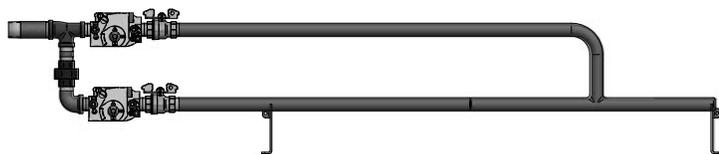
**Figure 8-5**\_Circuits de gaz pour modèle 500 000 BTU/h
