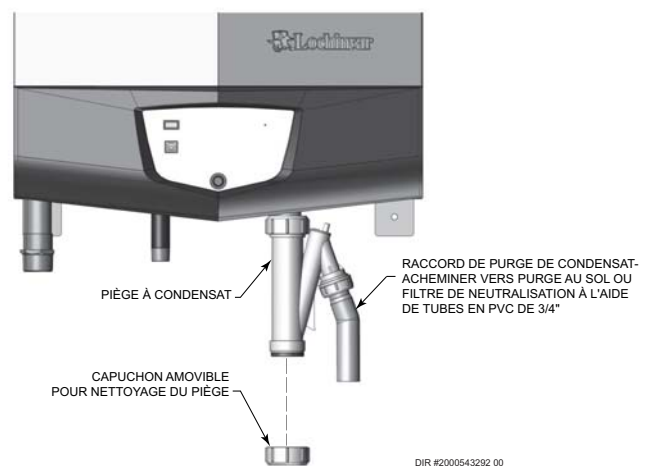
Figure 2-2 Rejet du condensat
